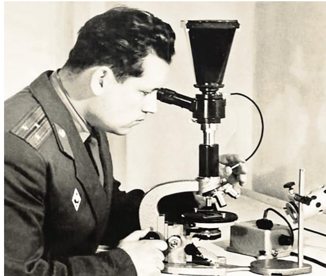
Начальник пожарно-испытательной станции Анатолий Александрович Косарев проводит исследования изолирующей способности разработанного пенообразователя ПО-3А, изготавливаемого Новочеркасским заводом синтетических продуктов. Результат – авторское свидетельство на изобретение пенообразователя. 1967 г.
