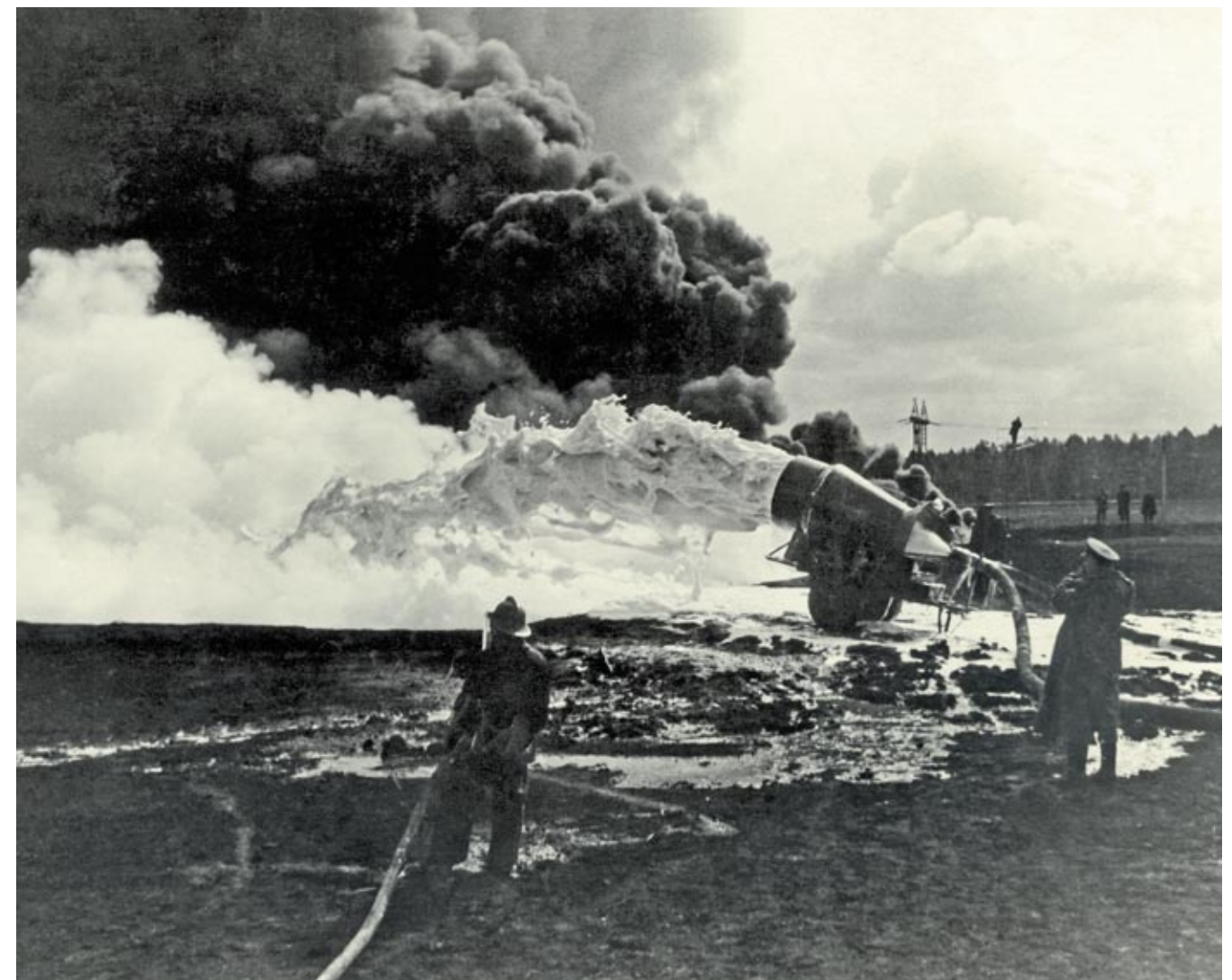
Испытание лафетного генератора (установка для тушения нефтепродуктов). Нач. 1980-х гг.
